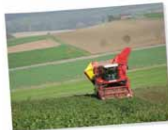
Op de hellingen in Zwitserland blijft de MAXTRON 620 dankzij de hellingcompensatie veilig in het spoor.
