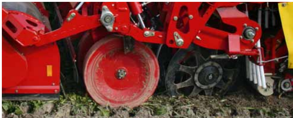
Zijdelings beweegbare ( \pm 40 mm) en hydraulisch aangedreven roterende rooischaren voor de optimale opname van de bieten, ook bij onregelmatig gewas
